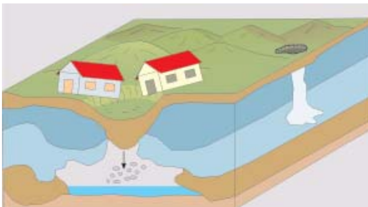
Figuras 14.118 e 14.119 – Moradia construída junto a dolinas, prática não recomendada, uma vez que o risco de afundamento em um local como este é alto (município de Almirante Tamandaré, PR).
