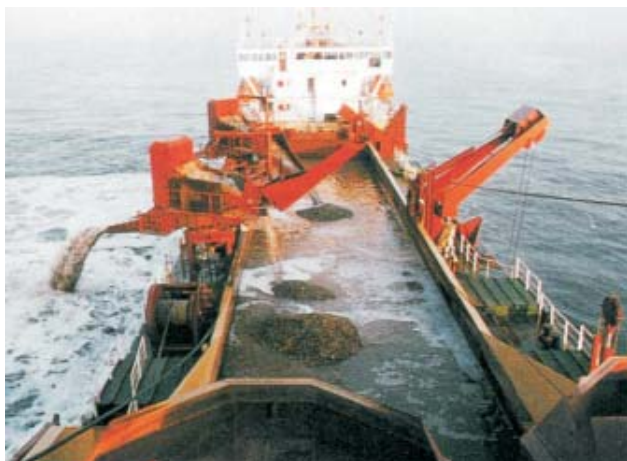
Figura 5.4 – Cascalho sendo minerado com utilização de draga (SUMMERHAYES, 1998).
