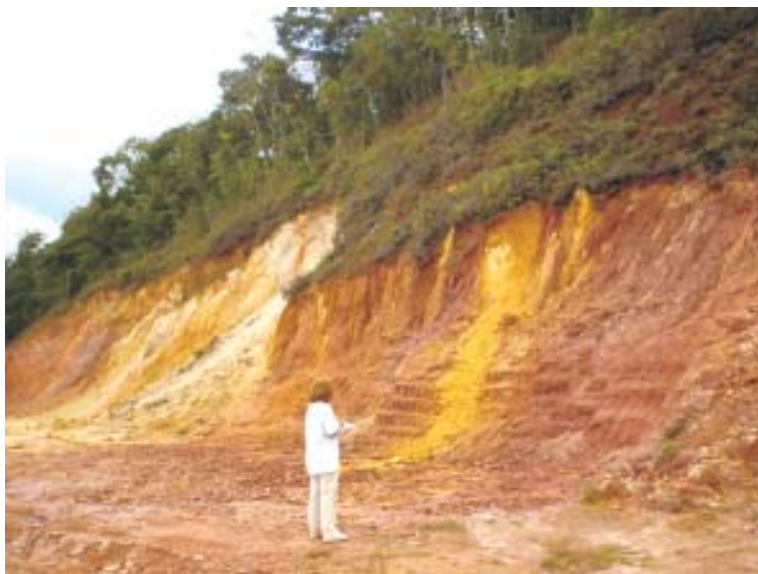
Figura 14.190 – Solo residual de um migmatito paraderivado, ou seja, produto da fusão parcial de uma seqüência vulcanossedimentar. As diferentes colorações são resultantes das variações composicionais dos materiais que compõem esse tipo de migmatito. As características físico-químicas são bem diferentes para cada um desses materiais, o que faz com que a qualidade agrícola dos solos varie bastante de local para local, de muito boa a muito ruim. As bandas de cor avermelhada são associadas a rochas ricas em minerais ferromagnesianos que liberam vários nutrientes; as esbranquiçadas, a rochas graníticas, pobres em nutrientes; as amareladas, a rochas calciossilicáticas, que liberam bastante cálcio.
