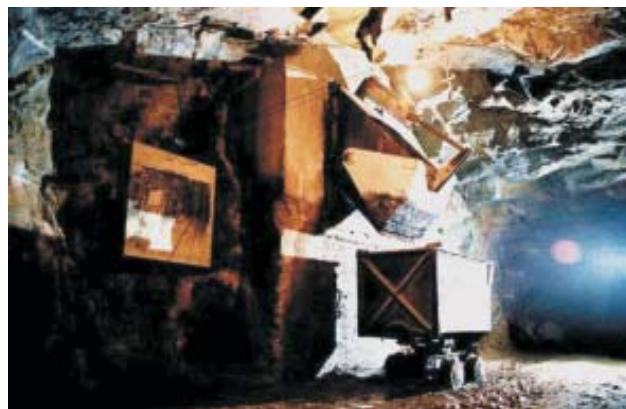
Figura 10.13 – Bica e vagonete utilizados para descida e retirada do minério (mina Brejuí, Currais Novos – RN) (fotografia de Joaquim das Virgens).
