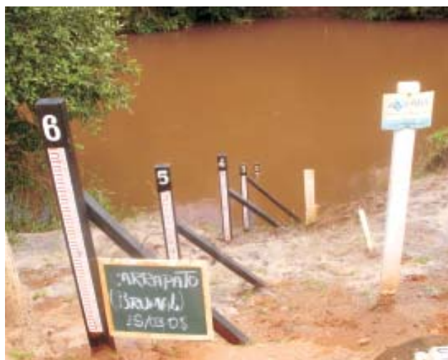
Figura 13.23 – Estação de medidas de descarga líquida e altura do nível da estação Carrapato (Brumal) no ribeirão Santa Bárbara (município de Santa Bárbara, MG) (CPRM/ANA).
