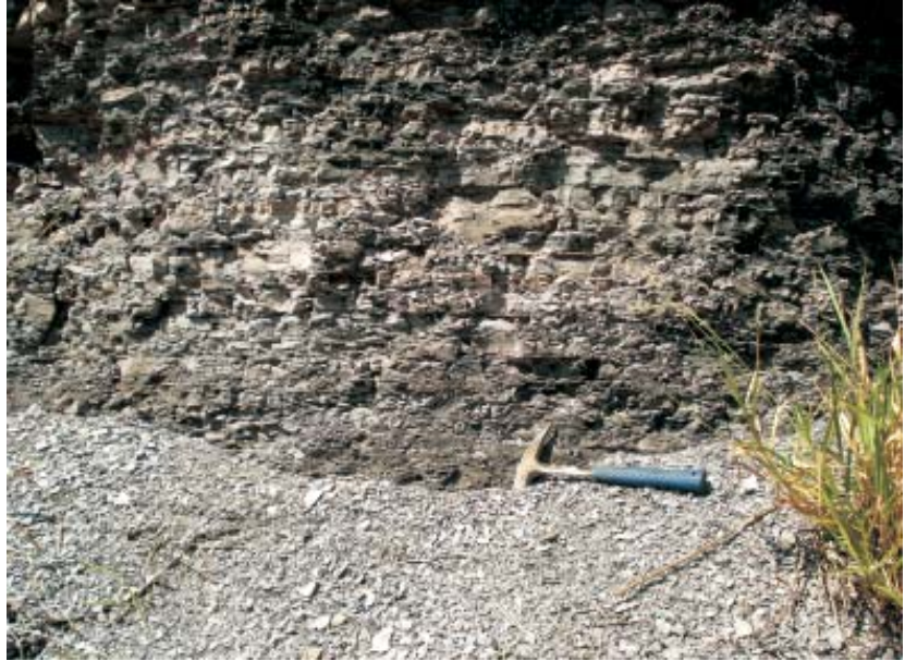
Figura 14.41 – Folhelho finamente laminado, que se desestabiliza com facilidade em taludes de corte (Formação Irati, SP).
