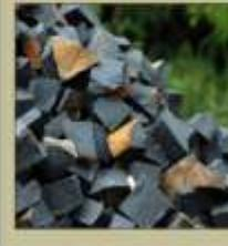
Por questões de resistência mecânica o diabásio encontrado em diques e pontas na região é o melhor tipo de material para a construção de calçadas e pavimentos. A cidade de Tibagi é conhecida por sua maior parte ser feita de **rochas de granito** e **diabásio**, sendo o granito o principal material utilizado na construção de pontas e diques.
