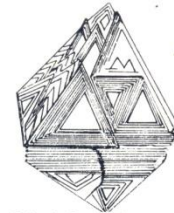
Cristal Octaédrique avec développement polycentré des arêtes
